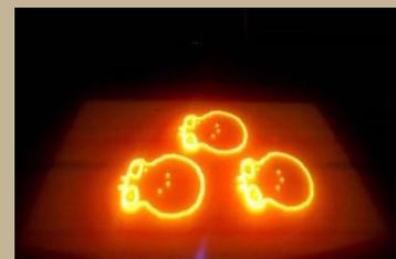
Utilizando un método similar al de la impresora que presentamos anteriormente, esta nueva máquina solidifica resina líquida a través de una técnica llamada **Direct Light Processing** (DLP), que consiste en la proyección de luz para dar forma y endurecer al objeto. Esta nueva máquina que promete una impresión de objetos pequeños en tan sólo seis minutos.
