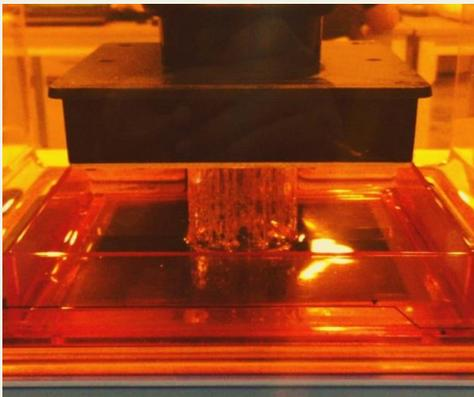
A la izquierda, se observa una de las máquinas de impresión 3D del #FabLabESAN utilizando tecnología SLA y resina transparente.
